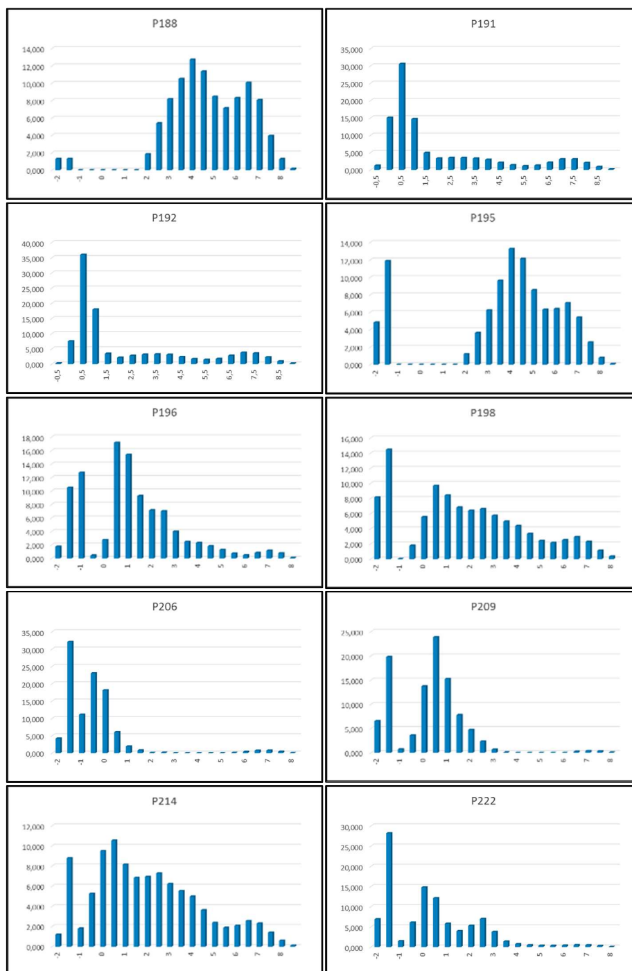
Figura 91: Histogramas de frequência simples da distribuição granulométrica das amostras de sedimentos do Depósito de baía no setor Noroeste da ISC.
