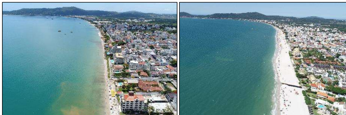
Figura 219: Vista geral da praia de Canasvieiras antes (à esquerda) e depois (à direita) das obras de alimentação artificial que compõe o Depósito tecnogênico dragado do setor Norte da ISC.
