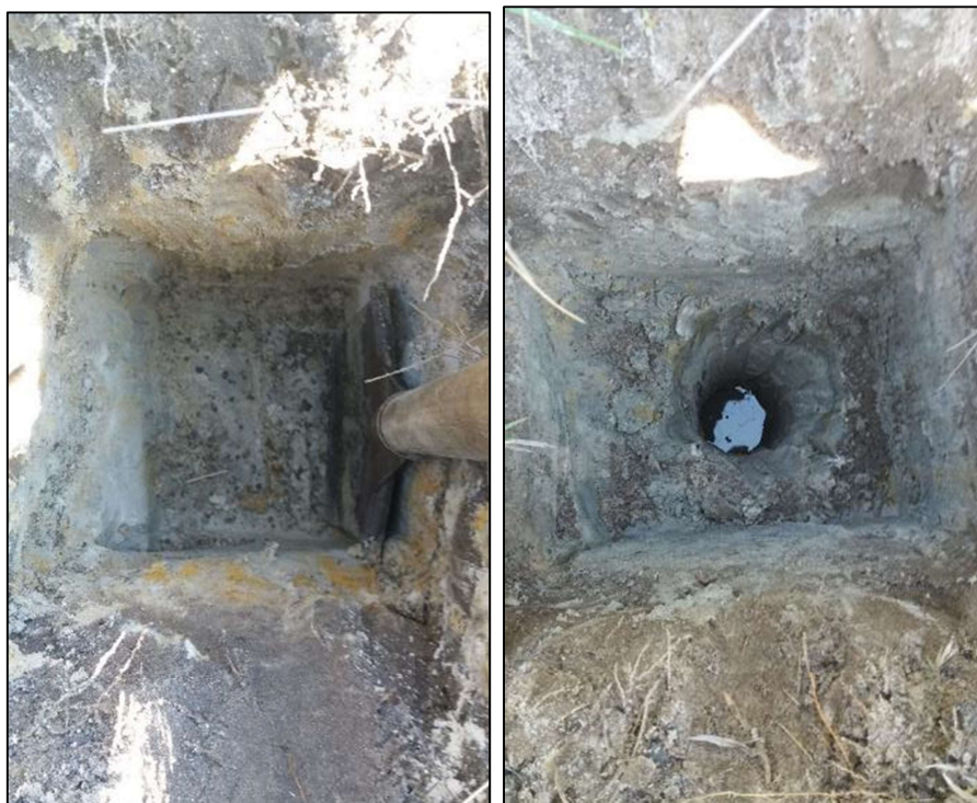
Figura 38: Cavas de superfície no terreno visando a coleta de material e a caracterização de estratos, em momento anterior a tradagem manual (esquerda) e posterior à tradagem manual (direita).
