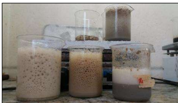
Figura 42: Processo de oxidação por H_2O_2 (35%) em andamento.
