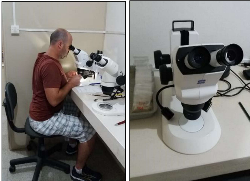
Figura 49: Triagem de grãos executada em placa de petri com apoio de lupa binocular (estereomicroscópio) da marca Zeiss , modelo Stemi 508 .
