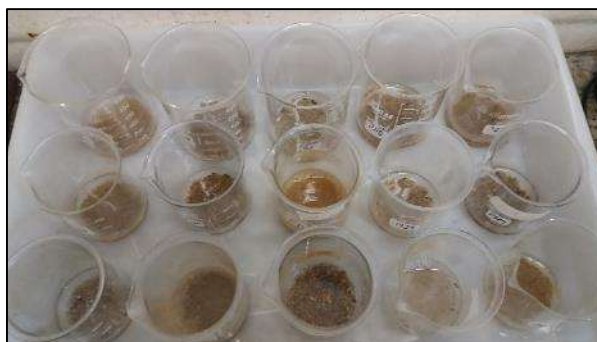
Figura 44: Processo de dissolução por HCl em andamento.
