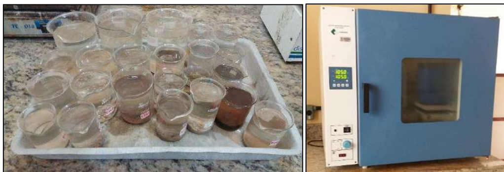
Figura 40: À esquerda, amostras em decantação após processo de lavação para retirada de sais solúveis; à direita, processo de secagem das amostras em estufa.
