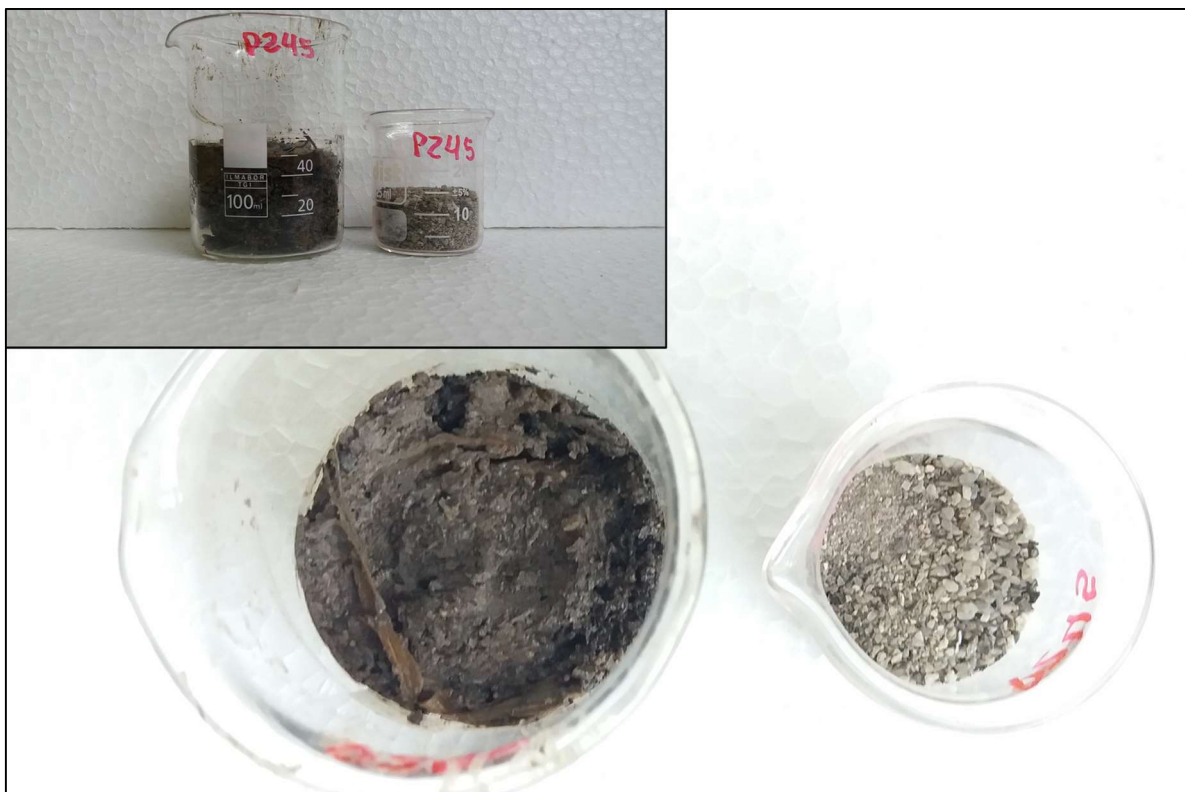
Figura 43: Detalhe da amostra P245 antes e depois do processo de oxidação por H_2O_2 (35%).
