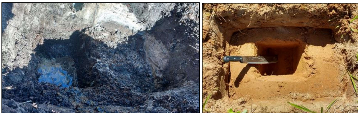
Figura 36: Cavas de superfície do terreno, visando a coleta de material com tradagem e a caracterização de estratos e estruturas sedimentares.
