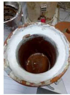
(c) Revestimento de gesso.
