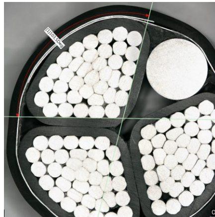
Figura 9 - Imagem fornecida de um cabo BT
