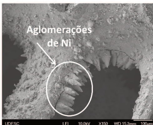
Figura 24 – Imagens em MEV de espumas sem revestimento e impregnada com Ni, evidenciando as regiões com aglomerações de metal.
