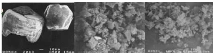
Figura 3 – Imagens de MEV de partículas de alumina: a) d = 52 \mu\text{m} ; b) após 48 horas em moinho de bolas com d = 6 \mu\text{m} ; c) após 312 horas em moinho de bolas, com d = 2 \mu\text{m} .
