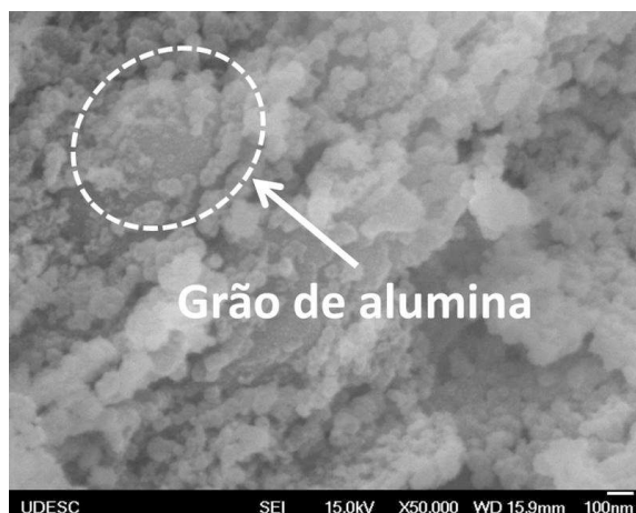
Figura 27 – Imagem em MEV de espuma com recobrimento e Ni ampliada em 50.000x.
