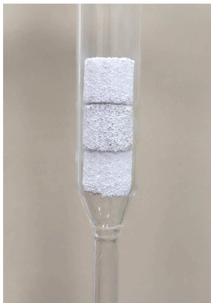
Figura 10 – Imagem tirada das 3 espumas de alumina, sem metal, utilizadas para realizar teste de branco.
