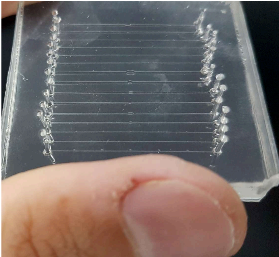
Figura 6: Micromodelo com diversos microcanais utilizados para reproduzir no laboratório fenômenos que ocorrem no processo de recuperação de petróleo.
