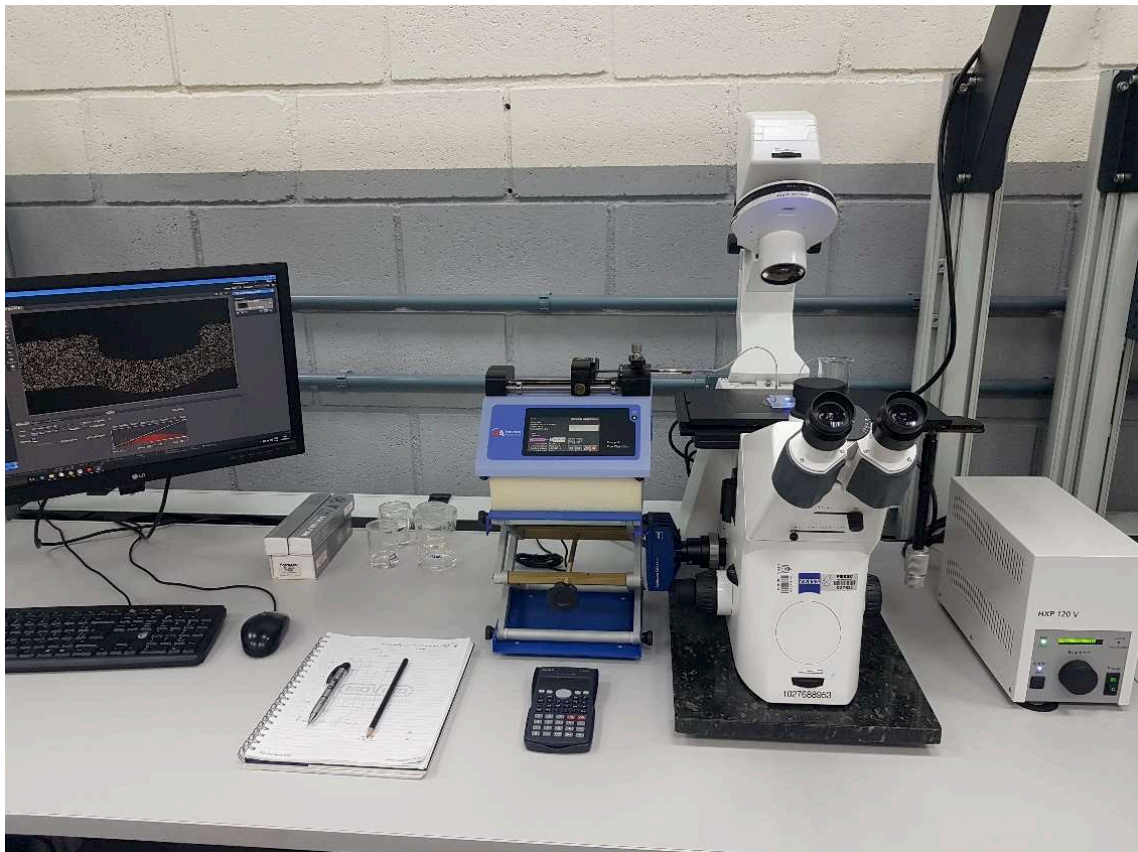
Figura 19: Bancada experimental utilizada no trabalho para a execução da técnica \mu PIV.
