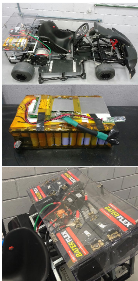
Figura 11 – Equipamentos utilizados: Kart elétrico, bateria de lítio e conjunto de baterias de chumbo ácido.
