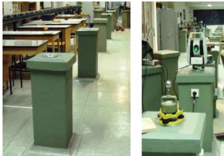
Figura 5 – Estrutura de uma linha de base para calibração direta de MED.
