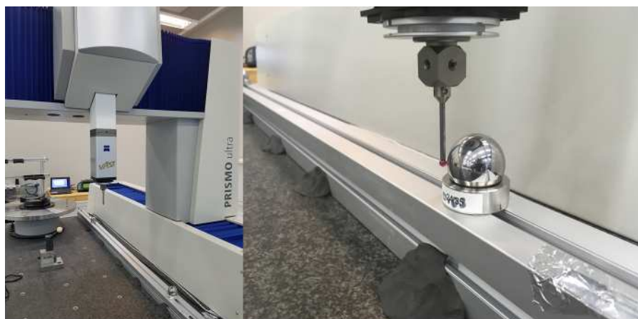
Figura 15 – Calibração do conjunto barra-padrão, ninhos e esfera.
