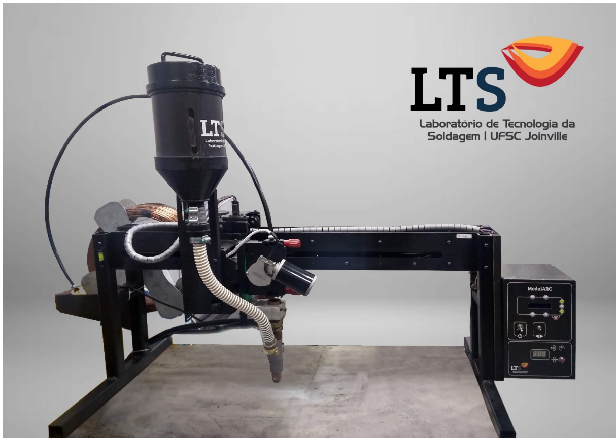
Figura 18 - Dispositivo de deslocamento de tocha posicionado para soldagem com tecimento transversal
