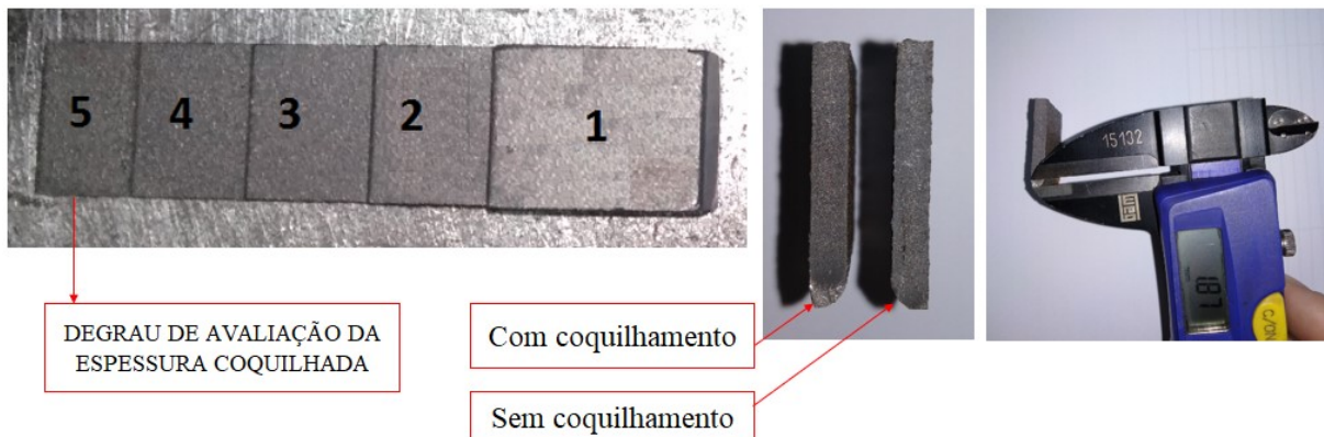
Figura 36 – Método de medição do defeito de ferro duro.
