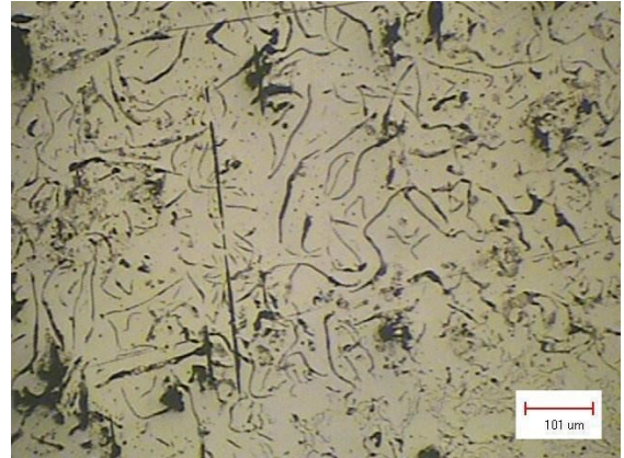
Figura 55 B: Estrutura composta por ilhas de grafita tipo “D” e Grafita tipo “A” com tamanhos 3, 4 e 5.
