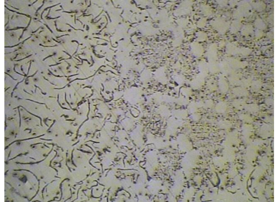
Figura 45 B: Estrutura composta por ilhas grafita “D” e grafita “A” com tamanhos 4 e 5.
