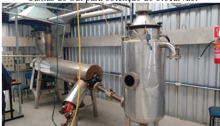
Figura 5 - Reator de pirólise piloto de parafuso semi-contínuo utilizado na Universidade de Caxias do Sul para obtenção do biocarvão.
