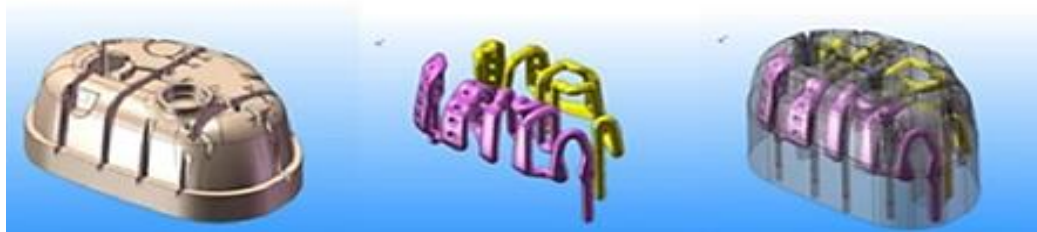
Figura 6 – Exemplo de peças produzidas com canais de resfriamento conformados (representados em coloridos).
