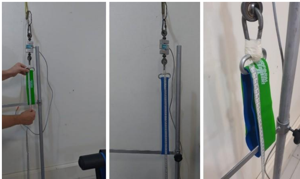
Figura 12 - Haste horizontal com a mensuração dos três níveis de resistência das bandas elásticas, no Laboratório de Avaliação e Reabilitação do Aparelho Locomotor (LARAL) da UFSC Araranguá/SC. Fonte: Autor, 2020.
