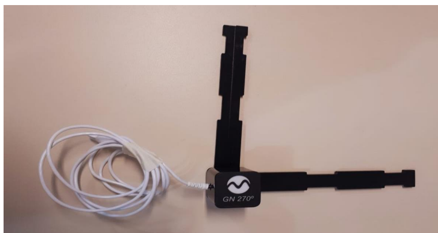
Figura 15 - Eletrogoniômetro eletrônico, modelo Miotec GN 270°, que pertence ao Laboratório de Avaliação e Reabilitação do Aparelho Locomotor (LARAL) da UFSC Araranguá/SC. Fonte: Autor, 2020.
