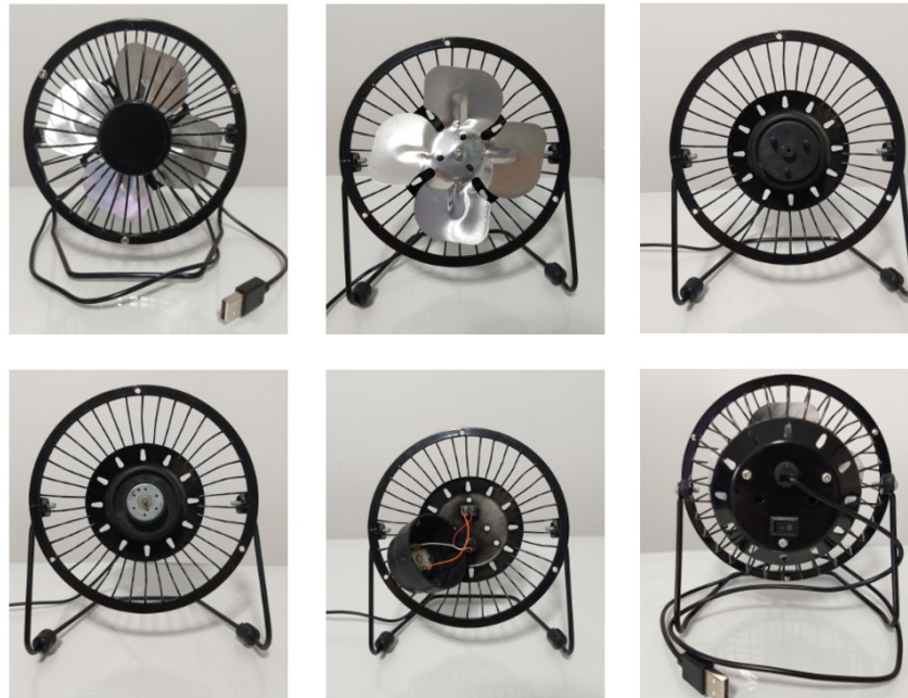
Figura 44: Ventilador metálico desmontado.
