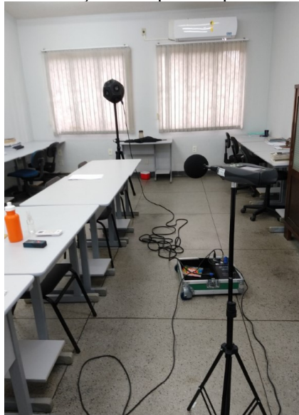
Figura 47: Medição da resposta impulsiva da sala 5.
