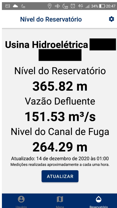
Figura 13 – Tela de exibição dos dados hídricos da barragem no aplicativo.
