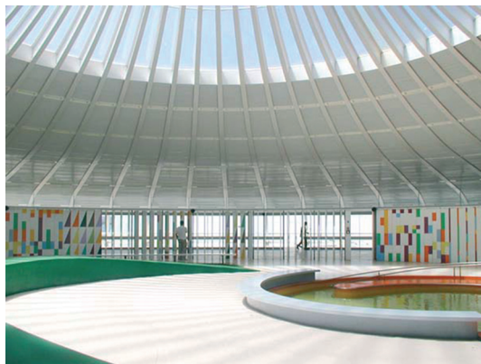
Imagem 9: Hospital Sarah em Brasília, sala de reabilitação. Lelé tira partido da iluminação natural e torna também a sala um ambiente agradável, contrariando a idéia que se faz de um hospital Fonte: Site www.vitruvius.com.br Foto: Butikofer & de Oliveira
