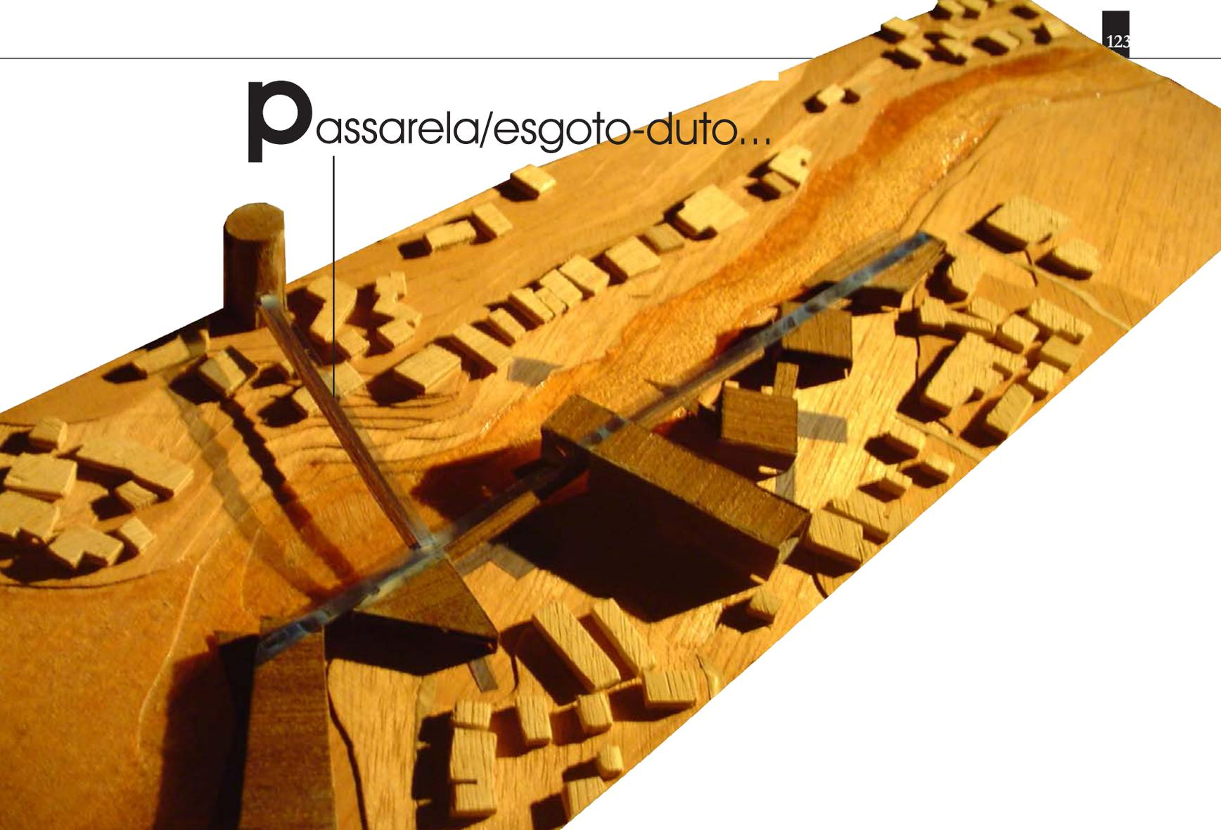
A água é tratada como elemento construtivo-educativo, descrevendo um ciclo: a água da chuva armazenada na cobertura, reutilizada na habitação e para lavagem das redes dos pescadores; a água servida captada e transferida pela passarela esgoto-duto por gravidade à micro estação de tratamento, incrustada no morro e voltada para o terreiro como uma seção didática de seu funcionamento. Desta, ela é devolvida aos canais, tanques, piscinas e finalmente mar, recriando o uso e completando o circuito.
