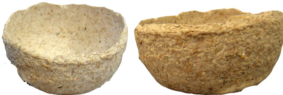
Fig. 39 | Teste da palha e casca aglutinadas com quiabo.
