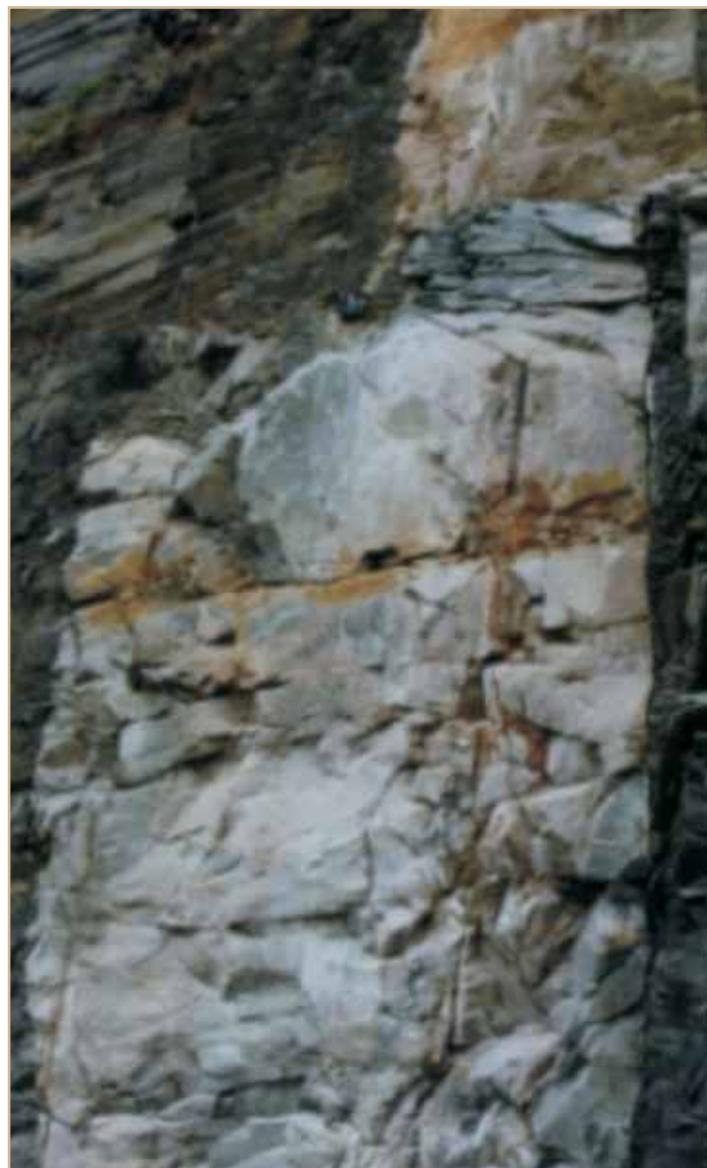
Detalhe diabásio/granito/diabásio na bancada da Pedreira PEDRITA.
