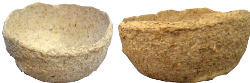
Fig. 41 | Teste de palha e casca aglutinadas com amido de arroz e babosa. Fonte: Acervo próprio.
