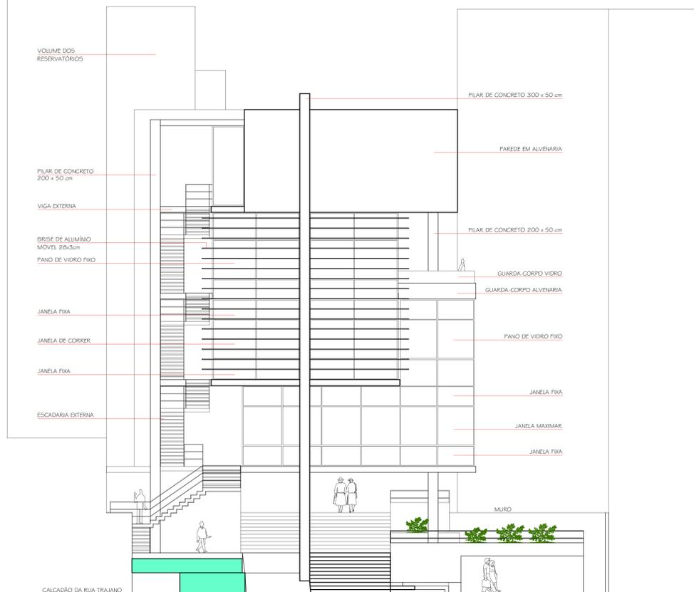
Percebe-se na fachada noroeste que a estrutura é formada pelo eixo de pilares centrais e por dois pilares laterais que ajudam a sustentar o peso da edificação. Algumas vigas de sustentação ficam aparentes e ajudam a dar forma ao projeto.
