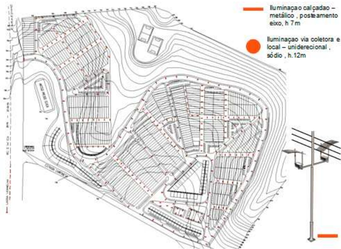
Figura 6 - Implantação do sistema de iluminação.
