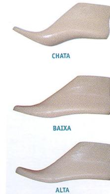
Figura 5 – Espessuras Bico
