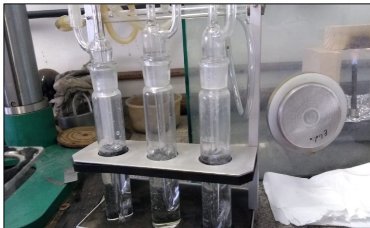
Figura 3 - Amostrador / coletor de material particulado (cinzas volantes).
