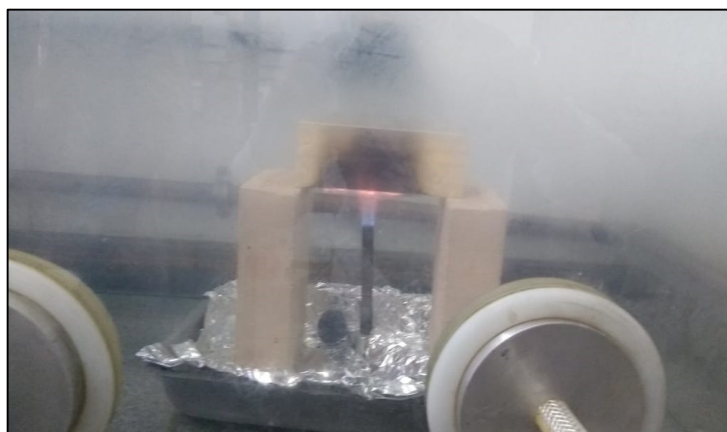
Figura 4 - Queima controlada de uma amostra de madeira dentro da câmara de combustão.
