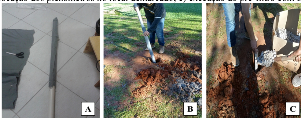
Figura 17 – Confeção dos piezômetros. a) detalhe do piezômetro com o filtro; b) colocação dos piezômetros no local demarcado; c) execução do pré-filtro com brita.
