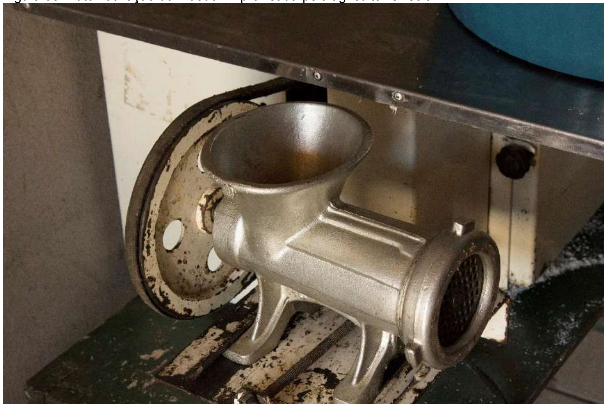
Figura 38: Automatização do moedor improvisada pelo agricultor Onécio
