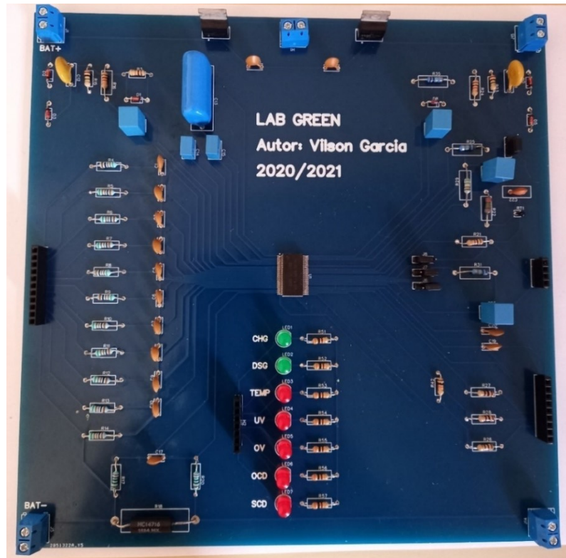
Figura 22 – Segundo protótipo do BMS, completo com todos os componentes
