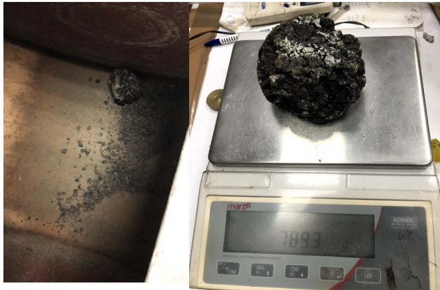
Figura 4.14 - Corpo de prova após a realização do ensaio Cántabro.
