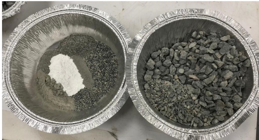
Figura 4.4 - Separação das frações finas e graúdas.
