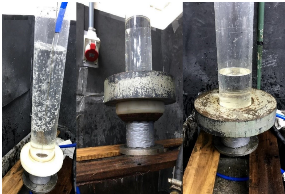
Figura 4.13 - Sistema de escoamento para cálculo de vazão.
