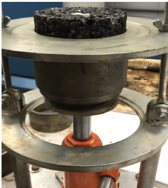
Figura 4.7 - Desmoldagem dos corpos de prova Marshall.
