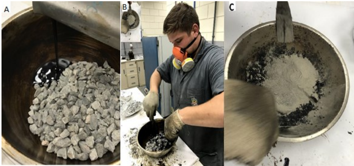
Figura 4.5 - Mistura de agregados graúdos com ligante HiMA: (a) Ligante HiMA sendo adicionado ao agregado graúdo; (b) Agregado graúdo sendo misturado ao ligante asfáltico; (c) Fração fina sendo adicionada junto ao agregado graúdo com ligante.
