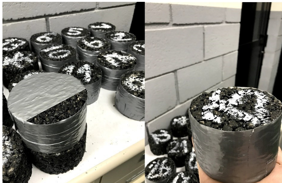
Figura 4.11 - Impermeabilização dos corpos de prova com fita.
