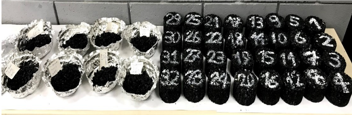
Figura 4.8 – Corpos de prova Marshall e MVR feitos para a pesquisa.
