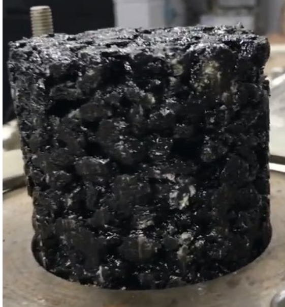
Figura 2.3 – Corpo de prova de uma mistura drenante BBDr com ligante HiMA.
