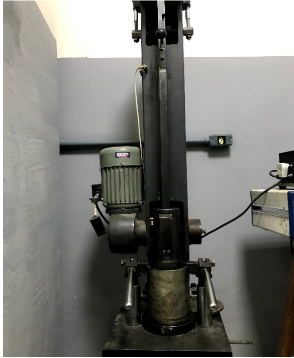
Figura 4.6 - Soquete Marshall automático com o CP posicionado para compactação.
