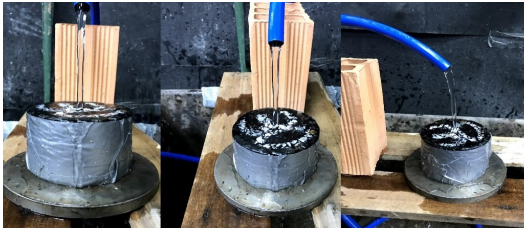
Figura 4.12 - Execução do ensaio de Vazios Comunicantes.
