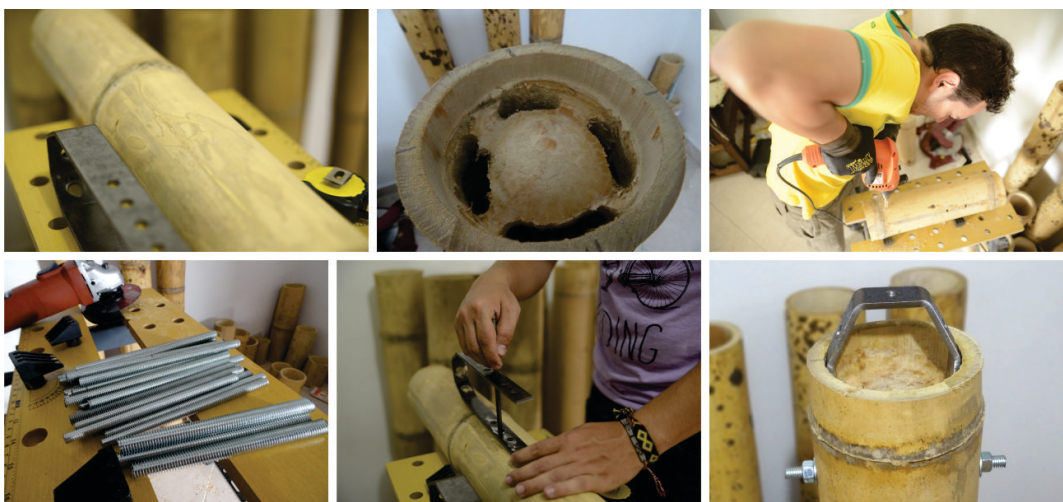
Figura4. Processo de montagem do terminal no colmo de Guadua. Fonte: Elaborada pelos autores.
