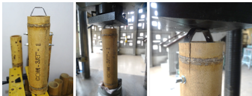
Figura 8. Procedimento do ensaio de compressão no corpo de prova COM – 3/8” – L. Fonte: Elaborada pelos autores.
