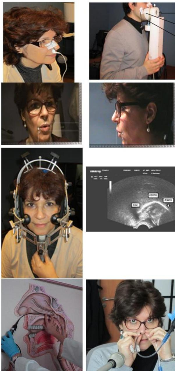
Figura 2. Instrumentos utilizados na coleta de dados: superior à esquerda, microfone nasal e captador piezo-elétrico; superior à direita, Estação EVA; no centro à esquerda, vídeo dos lábios de frente; no centro à direita, vídeo dos lábios de lado; inferior à esquerda, indicação da posição da sonda; inferior à direita, sonda inserida nas cavidades nasais para a fotonasografia.
