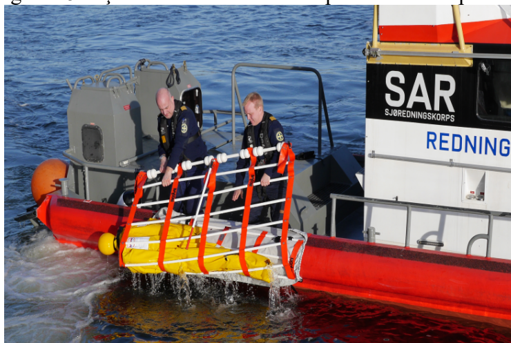
Figura 25 - Içamento de vítima com apoio de rede específica
