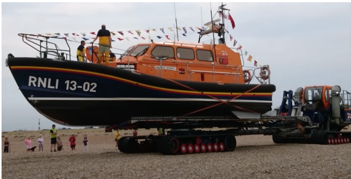
Figura 21 - Embarcação após ser girada na carreta, pronta para lançamento
