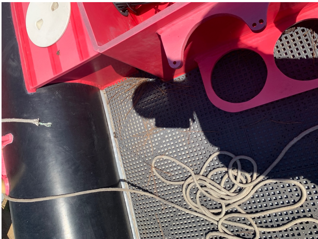
Figura 22 - Gradeamento para aumentar aderência no piso
