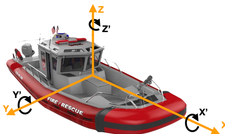
Figura 48 - Graus de liberdade de uma embarcação
