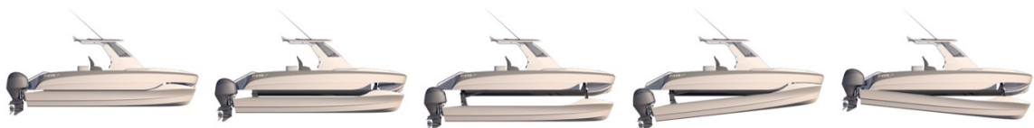
Figura 12 - Atuação do sistema de amortecimento
