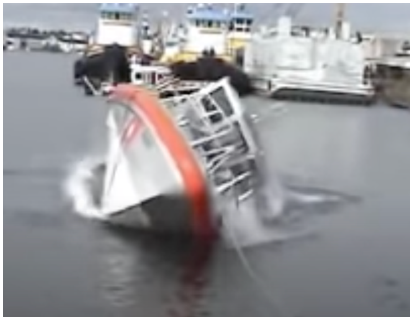
Figura 31 - Teste de emborcamento (após, retornando ao equilíbrio)
