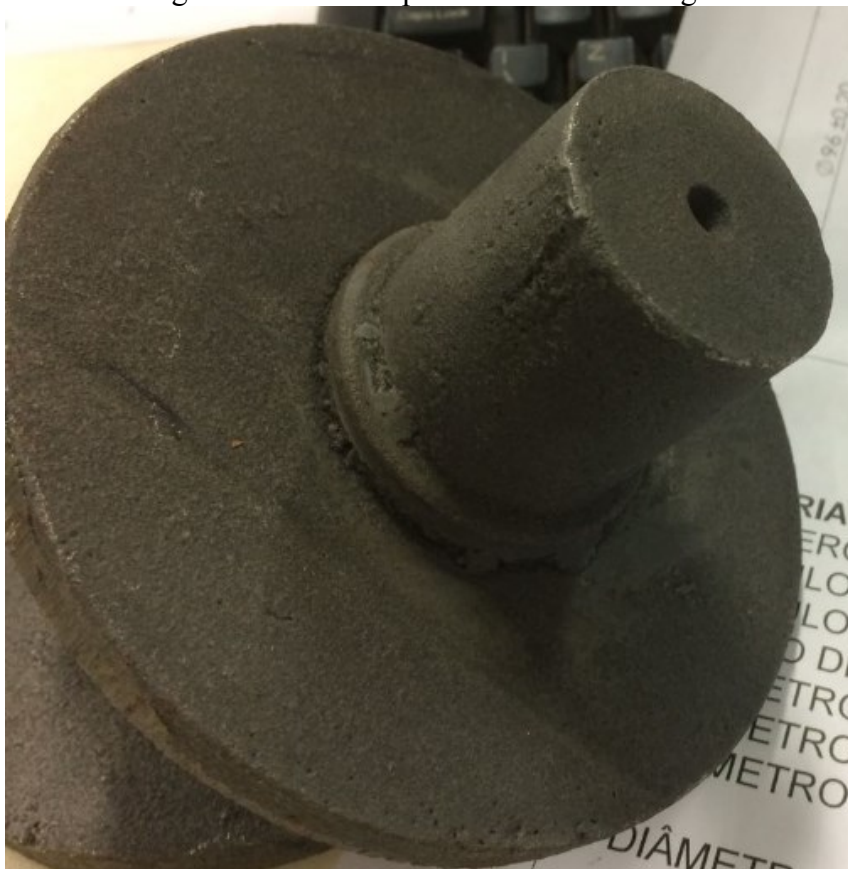
Figura 23 - Matéria prima fundida do flange.
