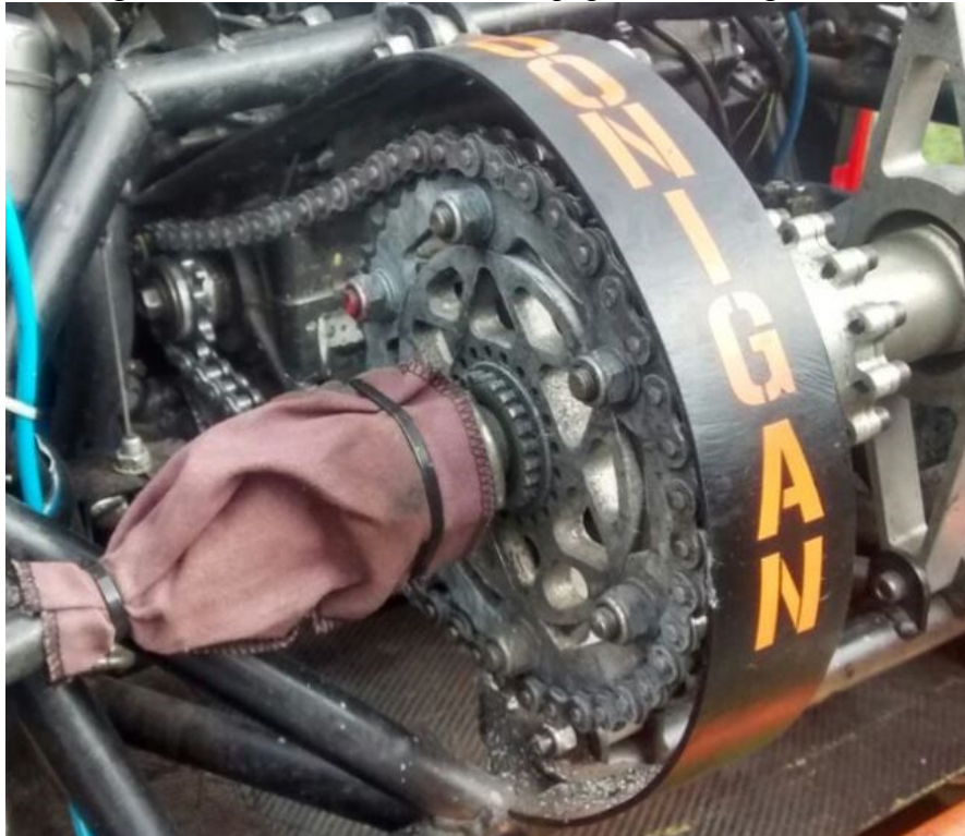
Figura 12 - Sistema Drivetrain Equipe V8 Racing Facens.
