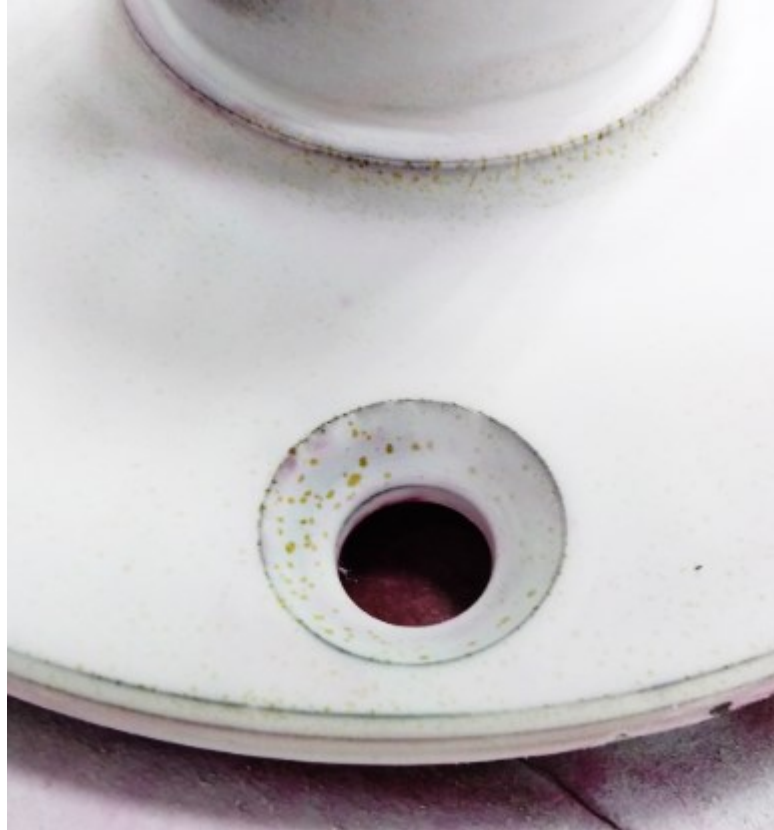
Figura 27 - Superfície do flange após a aplicação do revelador.
