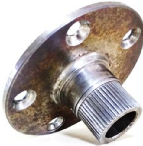
Figura 25 - Geometria final do flange produzido.
