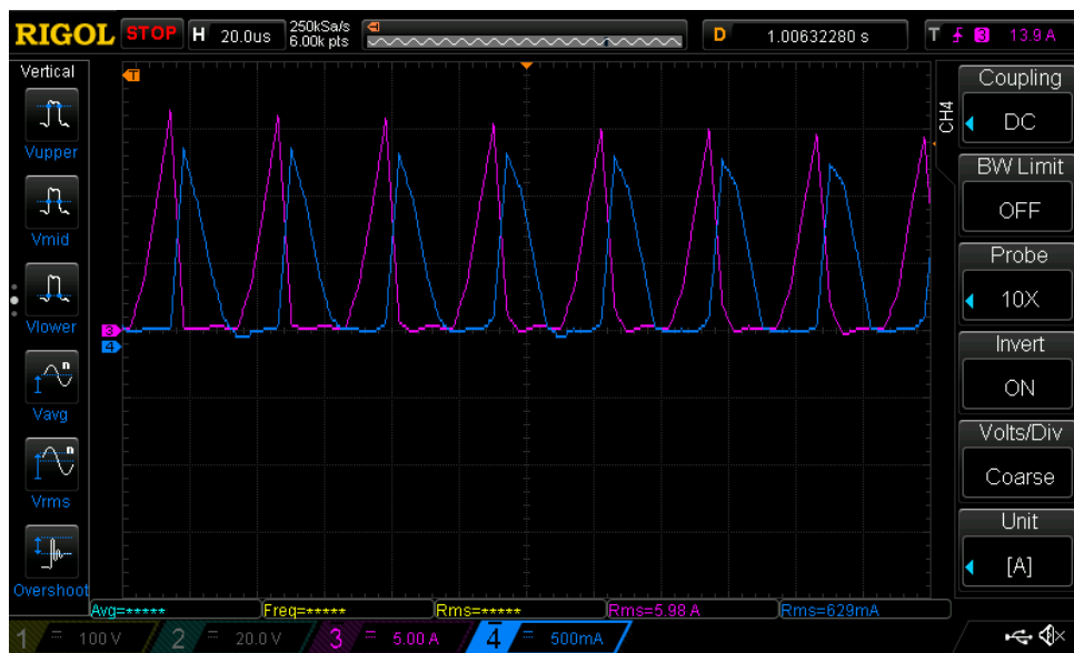
(b) Correntes nas bobinas do primário e secundário
