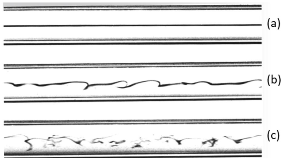
Figura 1 – Linhas de emissão em escoamentos laminar, de transição e turbulento no interior de um tubo
