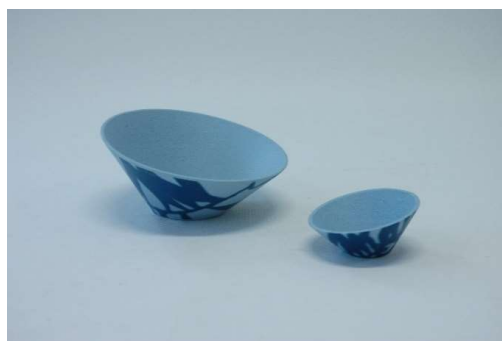
Figura 6 – Conjunto de taças em porcelana cuja pasta integrou resíduos recolhidos na estação de tratamento de águas da própria empresa (designer Alda Tomás, empresa SPAL)
