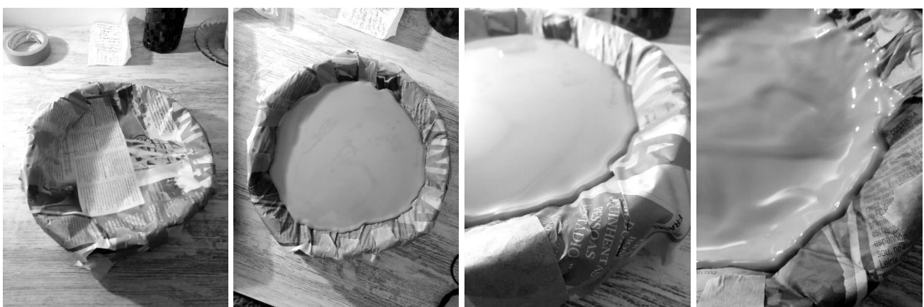
Figura 2 – Molde com jornal – Enchimento de molde – Visibilidade de criação de parede – Peça ainda líquida no molde
