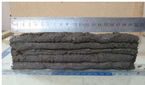
Figura 5: Ensaio de verticalização de compósito cimentício com 15% de substituição de (CV) sem aditivo superplastificante. Fonte: elaborado pelos autores.
