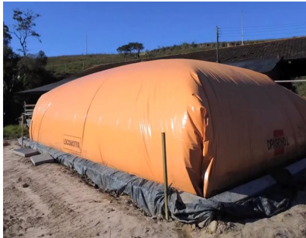
Figura 2: Biodigestor modelo canadense. Fonte: Epagri, 2021.
