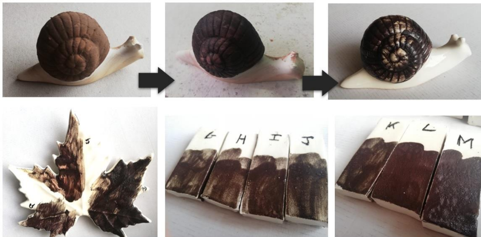
Figura 15 – Conjunto de imagens do processo (caracol vidrado nas condições de experimentação M, à esquerda antes da cozedura; no meio após uma cozedura, à direita após uma nova cobertura com vidrado transparente e nova cozedura; e e folha vidrada em três zonas distintas nas condições experimentais G, M e J).
