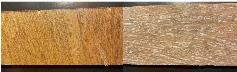
Figura 8: Diferença entre os dois lados do compósito. Fonte: elaborado pelos autores.
