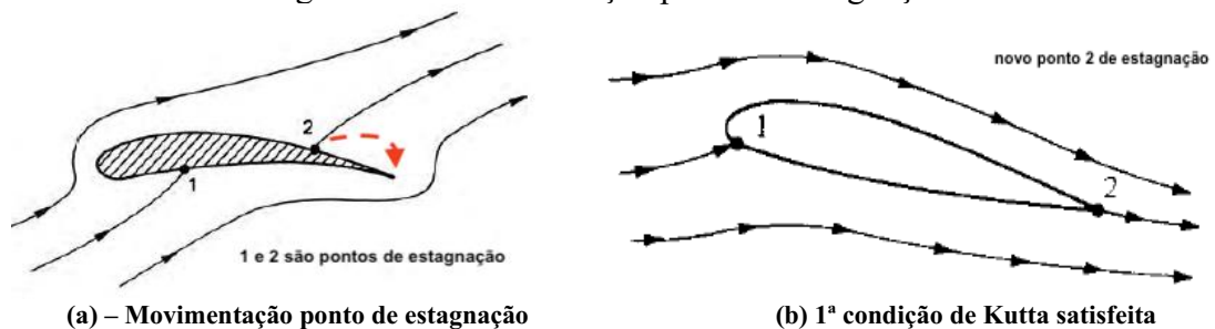
Figura 13 – Movimentação ponto de estagnação.
