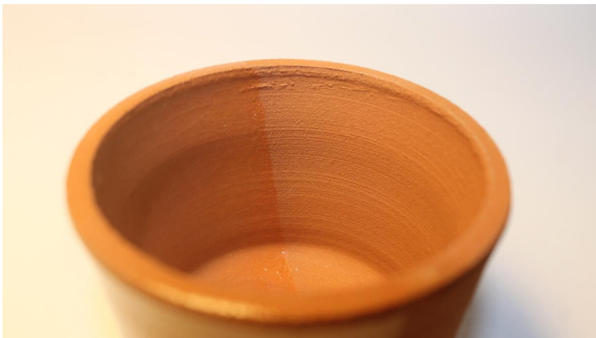
Figura 13 – Vidrado transparente parcialmente aplicado na pasta de modo a poder verificar-se a diferença entre as duas possibilidades.
