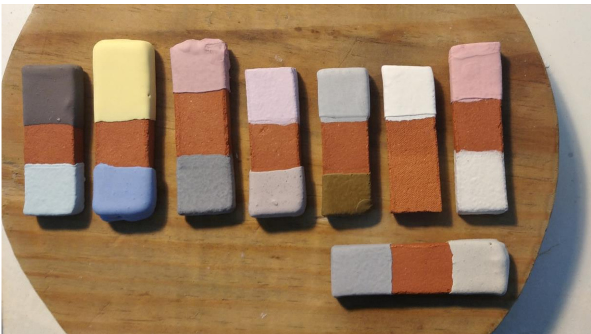
Figura 10 – Experimentação de vidrados sobre a pasta desenvolvida neste trabalho.
