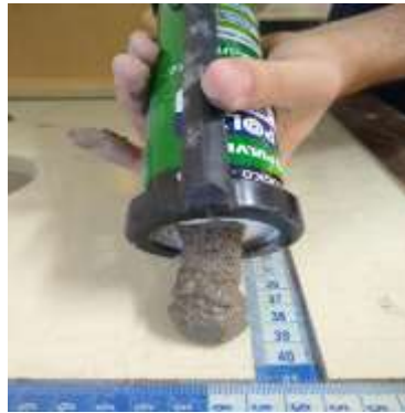
Figura 4: Material cimentício com substituição de 15% de (CV) sem aditivo superplastificante. Fonte: Elaborados pelos autores.
