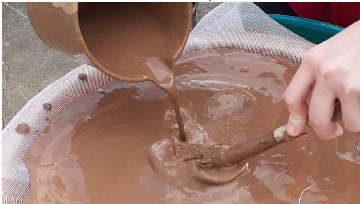
Figura 5 – Passagem da argila diluída por dois peneiros com malha de espessuras distintas
