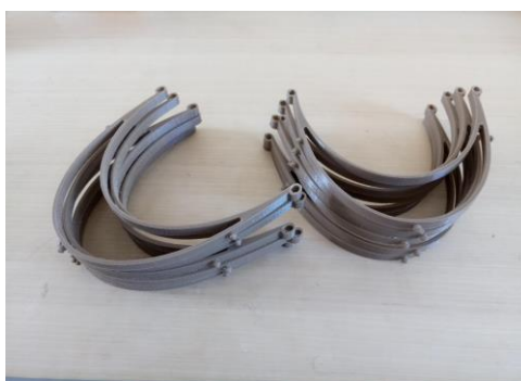
Figura 2 - Suportes para face shields produzidos utilizando impressão 3D. Elaborado pelos autores
