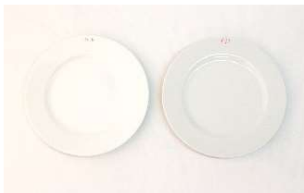
Figura 14 – Pratos de porcelana de hotel, à esquerda porcelana de alta resistência, à direita porcelana de resistência normal (empresa Vista Alegre).
