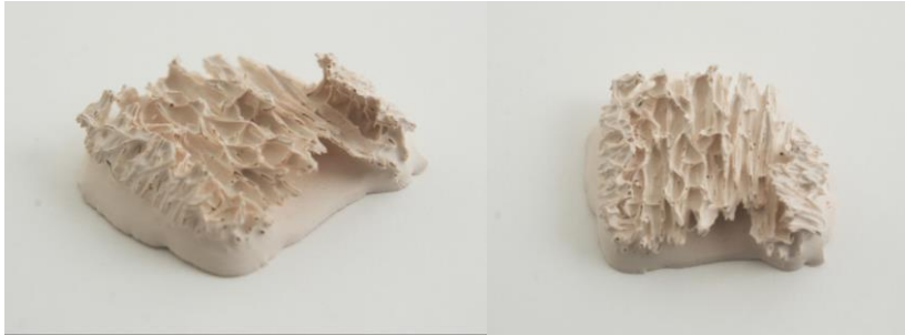
Figura 3: Amostra da bucha vegetal após ser cozida. Fonte: elaborado pelos autores.
