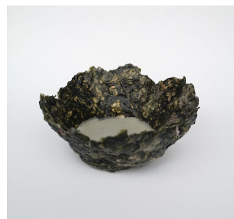
Figura 4: Fotografias das taças produzidas: à esquerda pasta de Urtigas Triturada + Papel + Cola de Farinha de Trigo; à direita pasta de Urtigas Triturada + Papel + Cola de Farinha de Trigo + Cera de Abelha. Fonte: elaborado pelos autores
