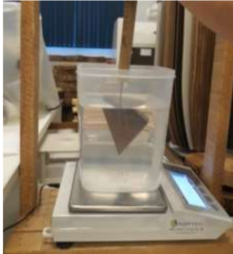
Figura 4 – Determinação do volume verde ( \text{cm}^3 ) através do método de imersão em balança analítica.
