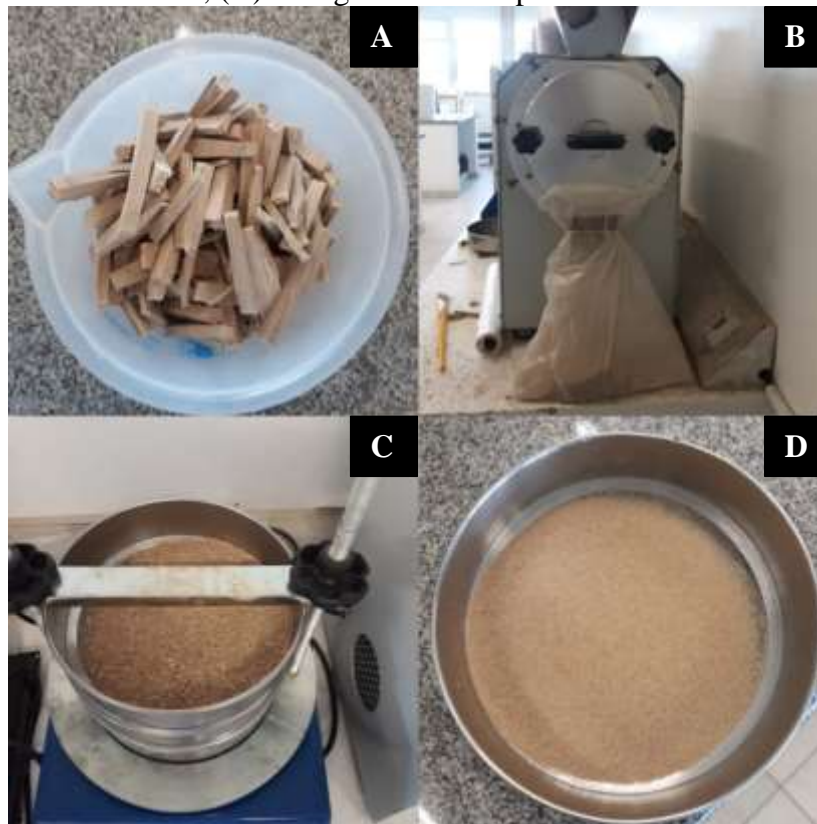
Figura 5 – Etapas de amostragem: (A) cavacos confeccionados a partir dos discos; (B) serragem obtida através do moinho Willey; (C) classificação da serragem em peneiras vibratórias; (D) serragem retida na peneira de 60 mesh.
