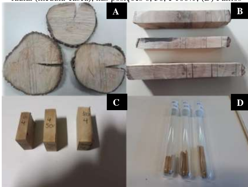
Figura 6 – Etapas de preparação do material para processo de maceração. (A) Discos da base com marcações dos anéis; (B) Baguetas, sentido medula-casca; (C) Amostras no sentido radial (medula-casca), nas posições 0, 50, e 100%; (D) Palitos
