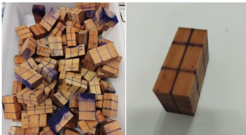
Figura 4 – Corpos-de-prova da madeira de Cupressus lusitanica MILL. com os sentidos anatômicos delimitados.
