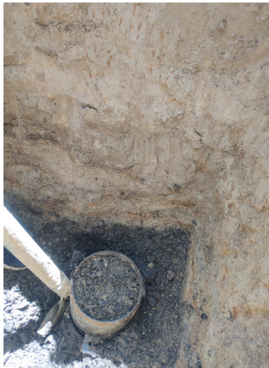
Figura 42 – Amostra 2 indeformada sendo retirada.
