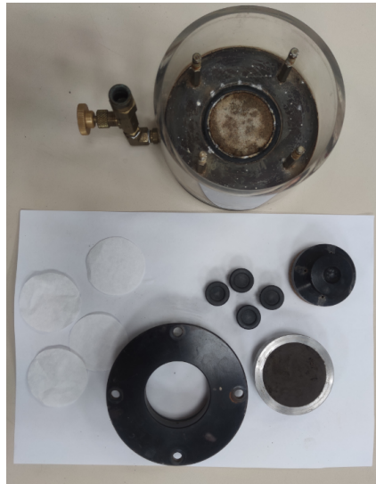
Figura 44 – Corpo de prova e componentes da célula de adensamento.
