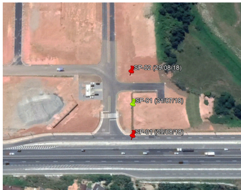
Figura 37 – Localização dos furos de sondagem SPT.
