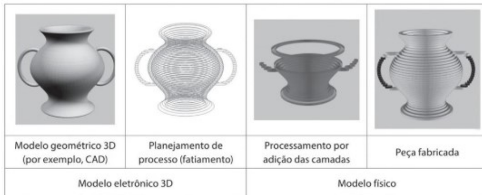
Figura 4 - Processos para impressão 3D. Na peça fabricada é comum a presença de linhas, que indicam as camadas sobrepostas - Fonte: Volpato (2017)
