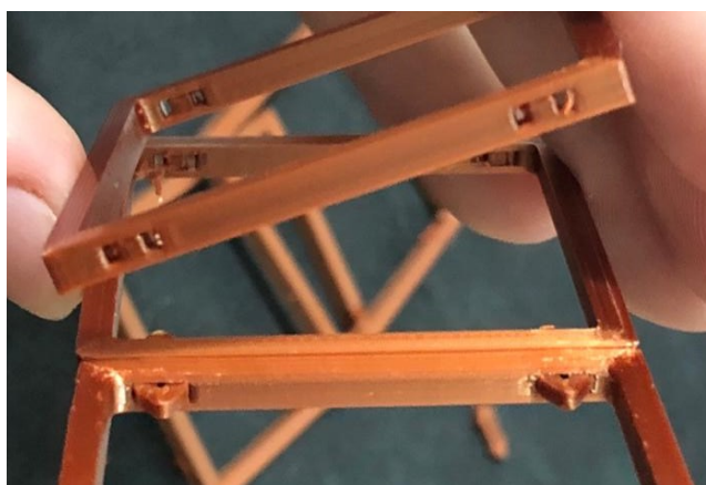
Figura 43 - Imagem mostra os suportes nas peças, na peça de cima ele ainda está na peça, e na de baixo já foi retirado e encaixado com o conector
