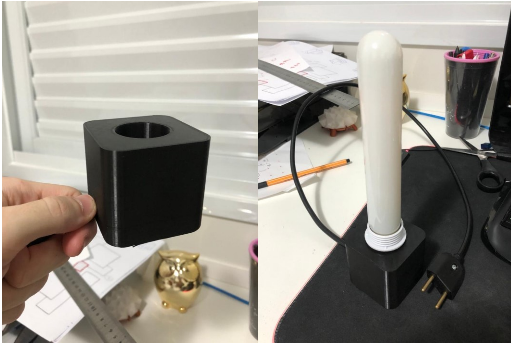
Figura 58 – A base é composta por uma cavidade para entrada quase que completa do bocal, e um espaço no fundo para levar o fio até um dos lados.
