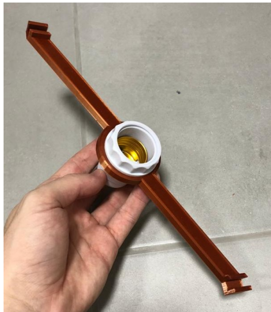
Figura 57 - A peça única usada para segurar a luminária pendente. possui uma cavidade para encaixe e ser rosqueada junto com a peça do próprio bocal.
