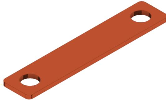
Figura 34: Modelo 3D da barra de cobre.
