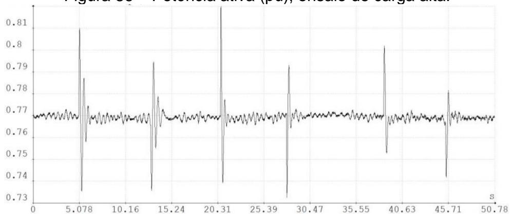
Figura 86 – Potência ativa (pu), ensaio de carga alta.
