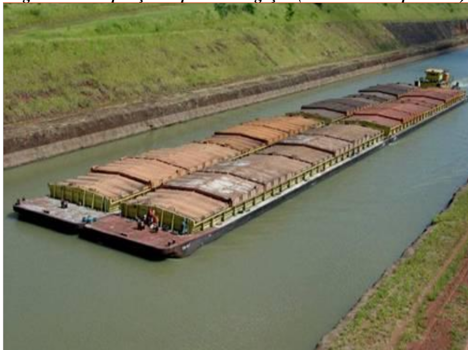
Figura 4 – Composição dupla de navegação (2 chatas e 1 empurrador)
