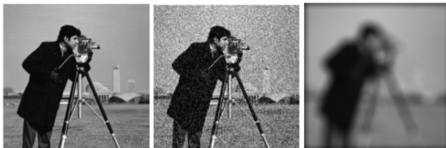
Figura 10 – Comparação de imagens com diferentes distorções, todas com MSE=1150. (a) Imagem original; (b) imagem com ruído gaussiano, SSIM=0,2591; (c) imagem com borramento gaussiano, SSIM=0,5114.
