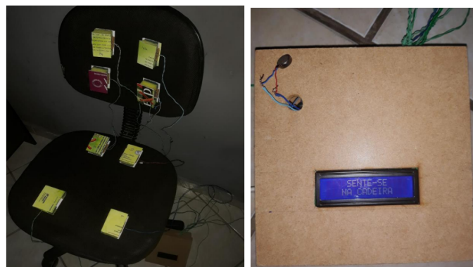
Figura 3 – Protótipo de uma cadeira com sensoriamento de contato
