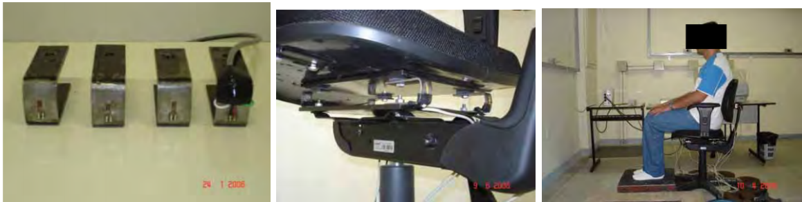
Figura 4 – Células de carga, fixação na cadeira e testes
