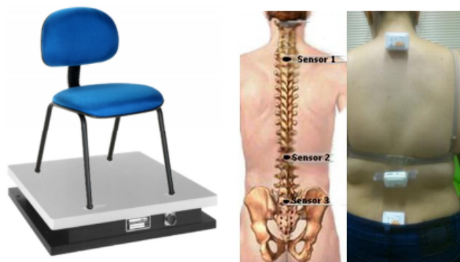
Figura 5 – Cadeira sobre plataforma de força e acelerômetros
