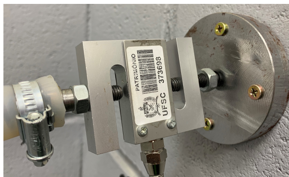
Figura 9 – Fixação do modelo na parede através da célula de carga.
