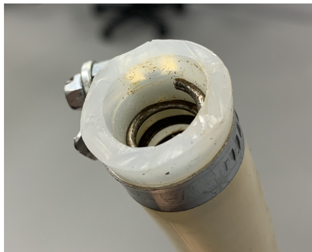
Figura 7 – Seção transversal do modelo experimental.
