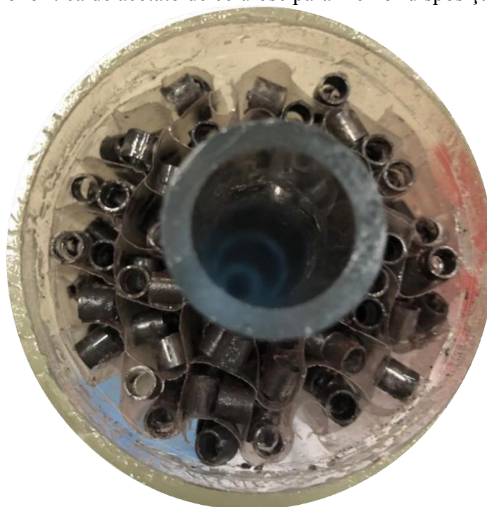
Figura 36 - Reator tubular preenchido com anéis Raschig recobertos com carepa e a estrutura monolítica de acetato de celulose para melhor disposição dos anéis.
