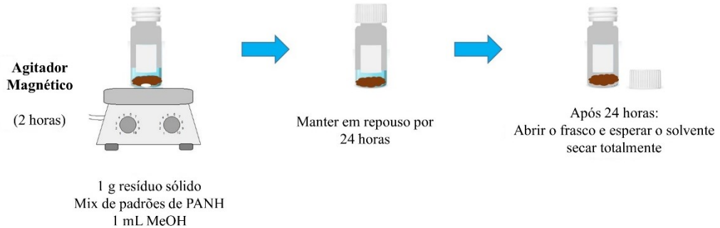
Figura 22. Esquema demonstrativo do processo de fortificação do resíduo sólido.
