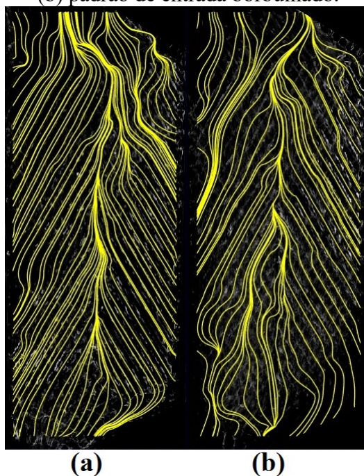
Figura 64 – Linha de corrente para a direção descendente: (a) padrão de entrada pistonado e (b) padrão de entrada borbulhado.
